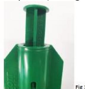
4. **Si le marqueur est en dessous de la ligne, assurez-vous d'utiliser des filtres propres et laissez le moteur fonctionner pendant 5 minutes supplémentaires avant de vérifier à nouveau. Si le débit est toujours inférieur à 160 L/min, ne pas utiliser le moteur. Le ramener au dépôt pour mise en révision.**
